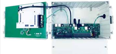
**4** Si el aluminio no está petroquelado, retire los cuatro tornillos de la tapa que protege la placa de micro, tal como se muestra en la imagen. Luego, con un martillo y un punzón o similar, rompa el troquelado en la zona indicada.
