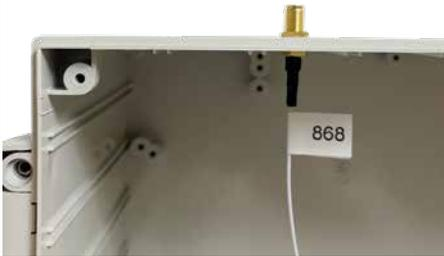
**7** Si le boîtier est prédécoupé, détacher la ou les parties concernées à l'aide d'un marteau et d'un poinçon ou d'un autre outil similaire. Si le boîtier n'est pas prédécoupé, faire un trou de 6,5 mm, en respectant les cotes suivantes.
