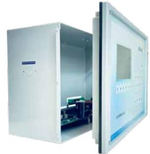
**5** Placer la ou les plaques de commande de l'AgroBee-L et les fixer à l'aide des vis et rondelles fournies, comme illustré ci-dessous.
