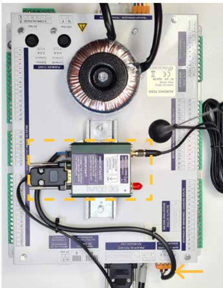
**5** Connecter le câble à l'aide des deux connecteurs à la nouvelle façade Agrónic 4500, et visser l'antenne au modem, comme illustré ci-dessous.
