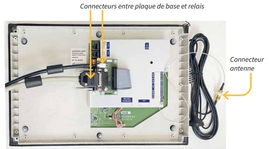
**7** L'antenne doit être installée en hauteur pour disposer d'un réseau optimal, ou à proximité d'une fenêtre. Ne pas laisser le câble de l'antenne enroulé, mais le dérouler complètement.
