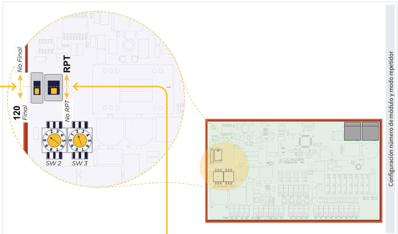
Configuración número de módulo y modo repetidor
